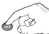
**[DE]** Drücken Sie die Taste „OFF“ für mindestens 7 Sekunden. Es ertönen 2 BEEP-Töne zur Bestätigung. Mit der Programmierung weiterer Deckenventilatoren ab jetzt unbedingt 4 Minuten warten, um Störungen zu vermeiden.
