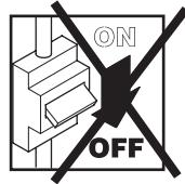
**TOUJOURS** utiliser l'interrupteur de l'appareil pour effectuer l'appairage. Lorsque l'alimentation est coupée puis rétablie au tableau électrique via le fusible, aucune touche de la télécommande ne doit être enfoncée pendant au moins 3 minutes.
